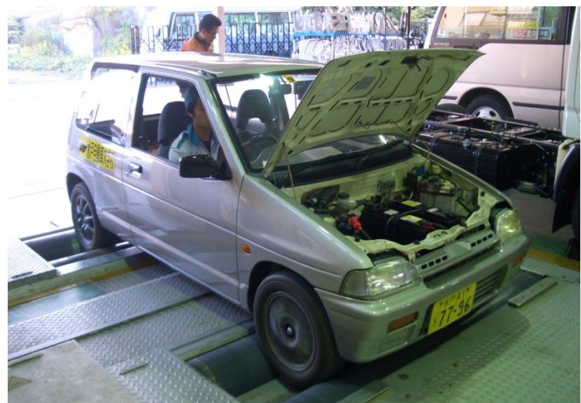
<シャシダイによる走行テスト> *このあと、走行不調が発生しました。原因はコントローラのヒートによる発熱防止制御のようでした。 内心、ヒヤヒヤもので焦りました。（10月30日）
